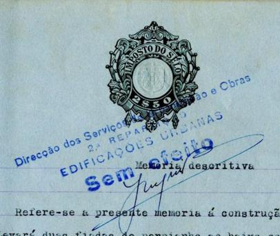
Refere-se a presente memoria á construção dum muro de vedação Levará duas fiadas de perpianho ao baixo como alicerces. As paredes de elevação serão de perpianho, ficando gateadas e caiadas.
